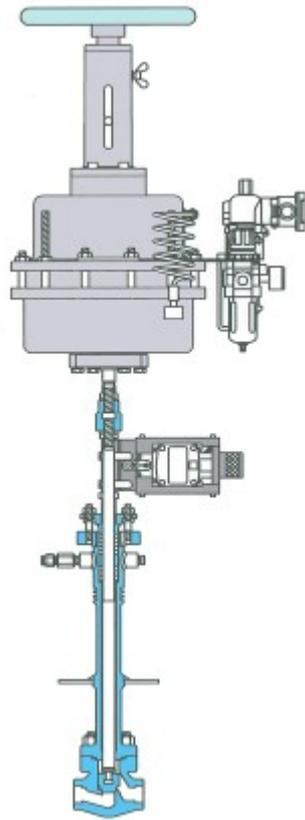
エアーシリンダー弁は、プラントの自動化及び緊急遮断弁に適しています。
